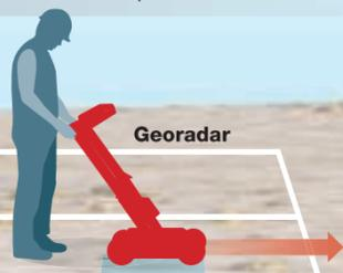
Il georadar con un'antenna permette di scandagliare **1 ettaro** di terreno in un giorno di lavoro
